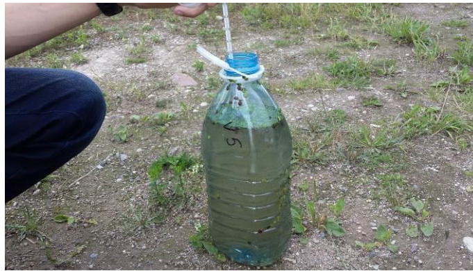
2.3 pav. Vandens mėginio temperatūros matavimas ėmimo vietoje
