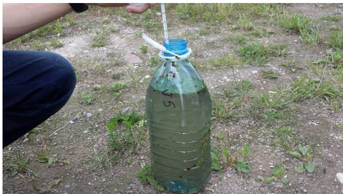
2.3 pav. Vandens mėginio temperatūros matavimas ėmimo vietoje
