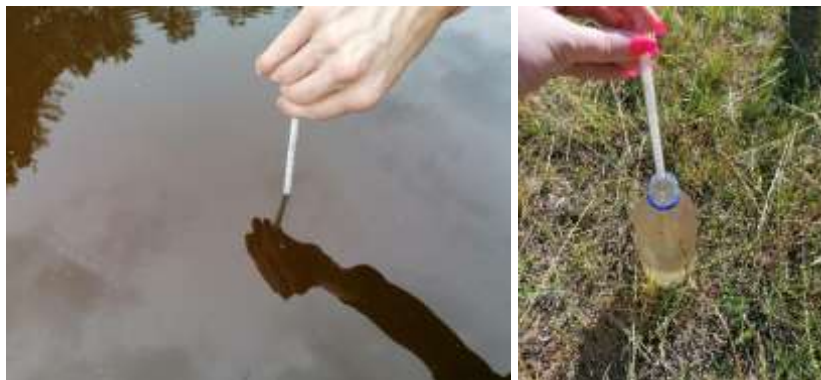
2.3 pav. Vandens mėginio temperatūros matavimas ėmimo vietoje
