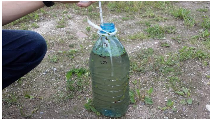
2.3 pav. Vandens mėginio temperatūros matavimas ėmimo vietoje
