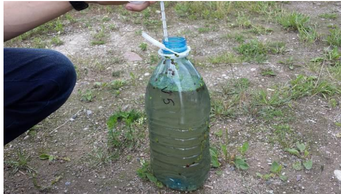
2.3 pav. Vandens mėginio temperatūros matavimas ėmimo vietoje
