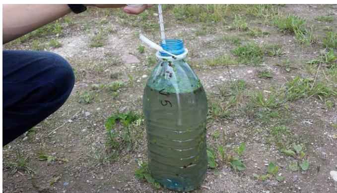
2.3 pav. Vandens mėginio temperatūros matavimas ėmimo vietoje
