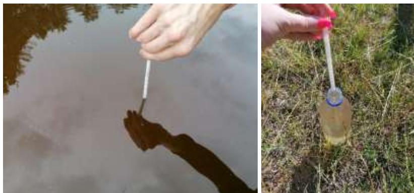
2.3 pav. Vandens mėginio temperatūros matavimas ėmimo vietoje
