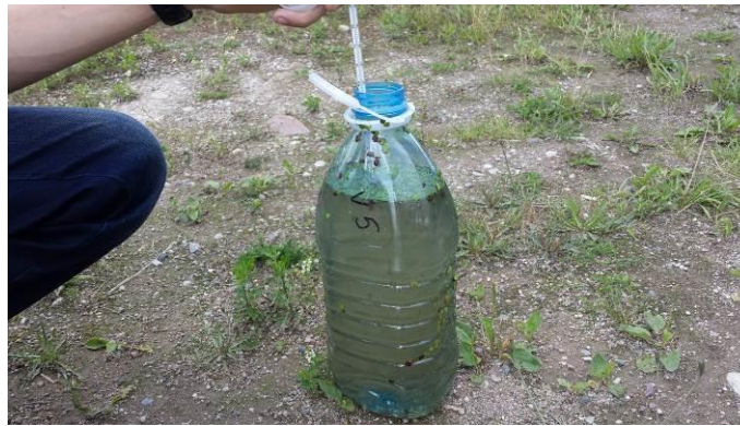
2.8 pav. Vandens mėginio temperatūros matavimas ėmimo vietoje
