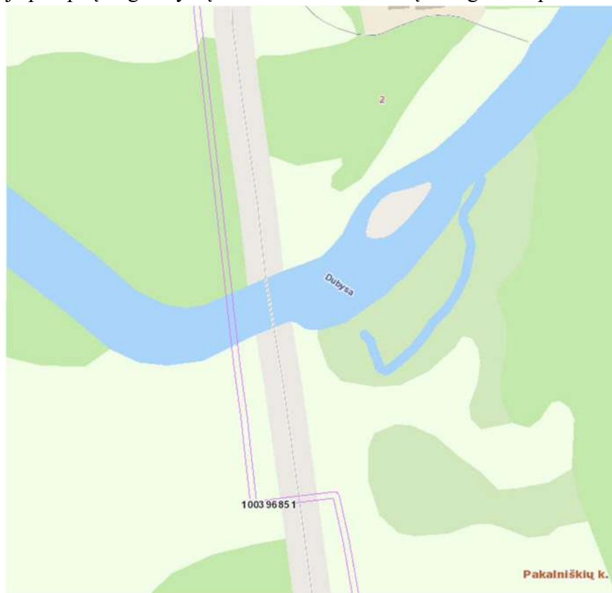
3 pav. Ryšių kabelio apsaugos zona ties tiltu
